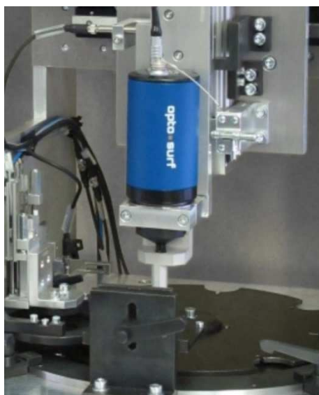
Abbildung 11. Messautomat mit Streulichtsensor
